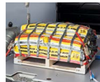
Gecombineerde ladingbeveiliging met ladingbeveiligingsnet en dwarsdragers
