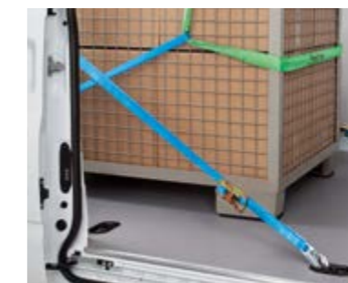
Vastzetten bovenkant van de lading met een rondstroop
